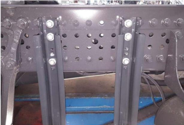
*So gelingt eine schnelle und sichere Montage ohne zusätzliches Bohren. Bei Rahmenversatz liefern wir auch Ausgleichsplatten in verschiedenen Stärken. Eine gut geplante und effiziente Vormontage des Ölbehälters ist das A und O.*
